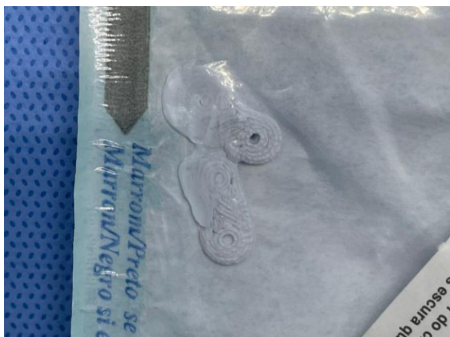
Figura 4 – Protótipo apresentando deformidades pós tentativa de esterilização.
